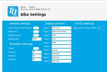
Unter dem Menüpunkt „Bike-Settings“ können jetzt die benötigten Ausgänge für die elektronische Schaltung bzw. die Beleuchtung freigeschaltet werden.
