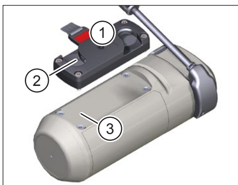
Abb. 3: Befestigen Sie den FIDLOCK® Force Connector am Range Extender
