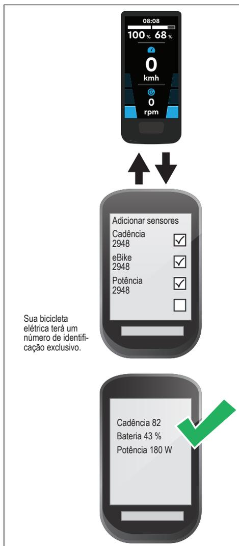
Fig. 8: Conexão da bicicleta elétrica ao computador de bicicleta
