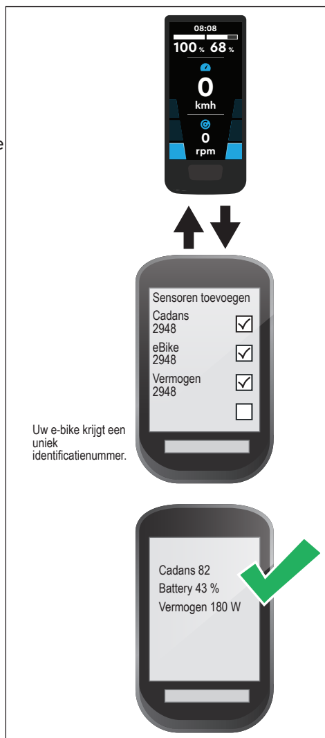
Fig. 8: Verbinding e-bike met fietscomputer
