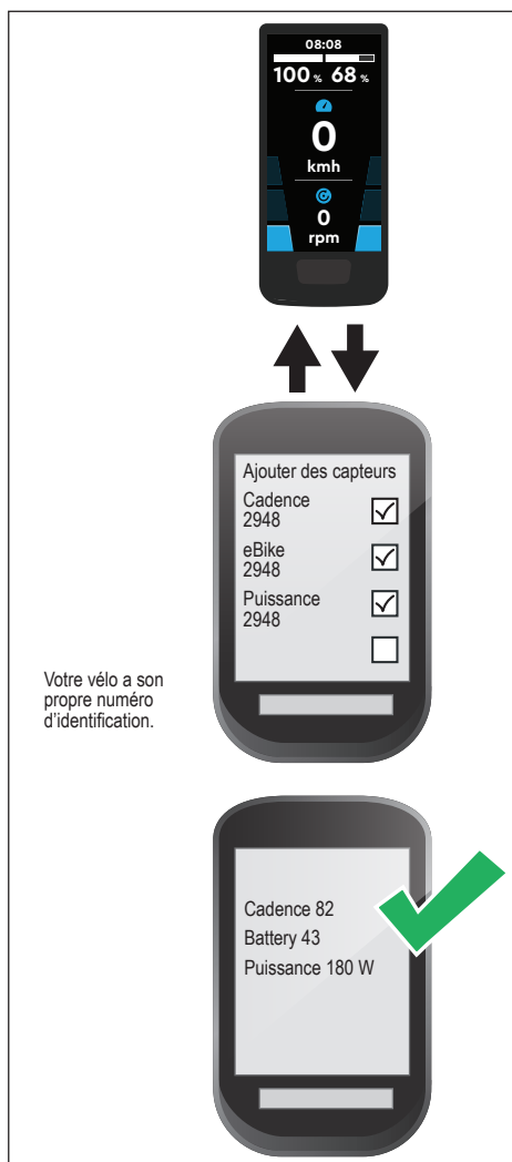
Fig. 8: Connexion entre le E-Bike et le compteur vélo
