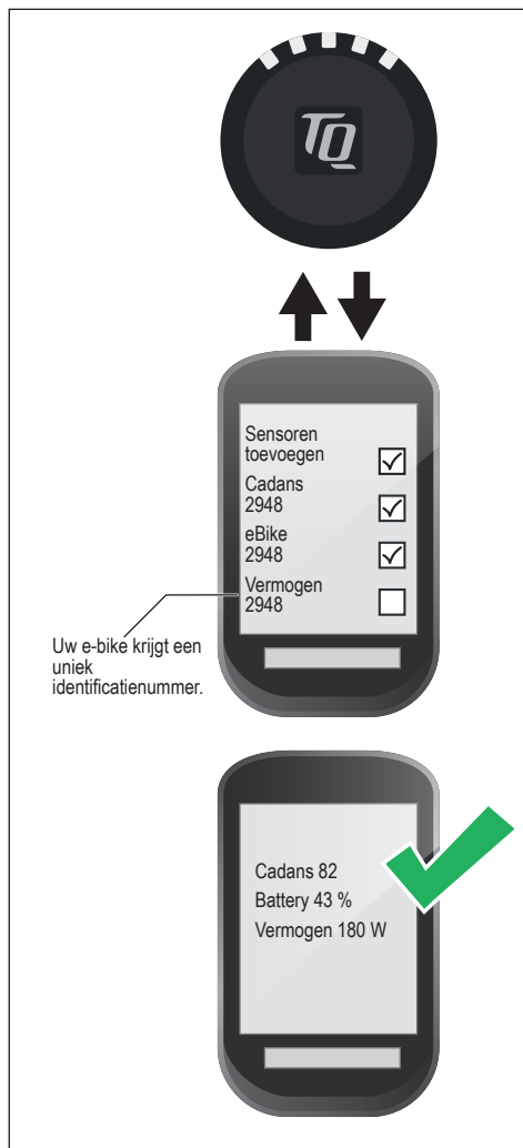
Fig. 6: Verbinding e-bike met fietscomputer
