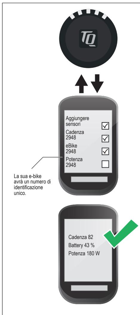
Fig. 6: Collegamento e-bike al computer da bicicletta
