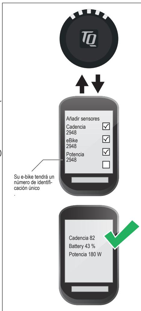
Fig. 6: Conexión de la e-bike al ciclocomputador
