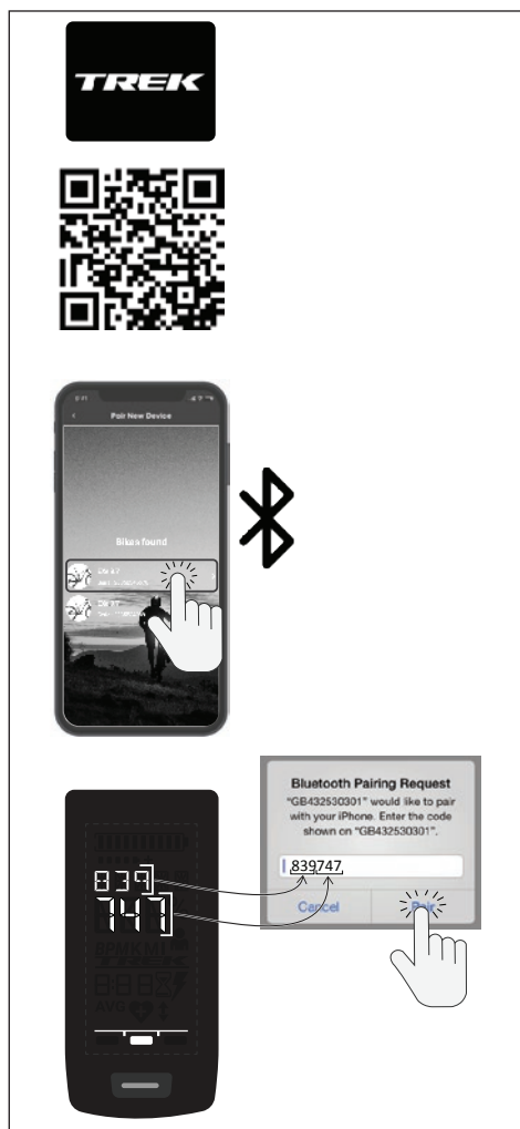
Fig. 7: Conexión E-Bike a Smartphone
