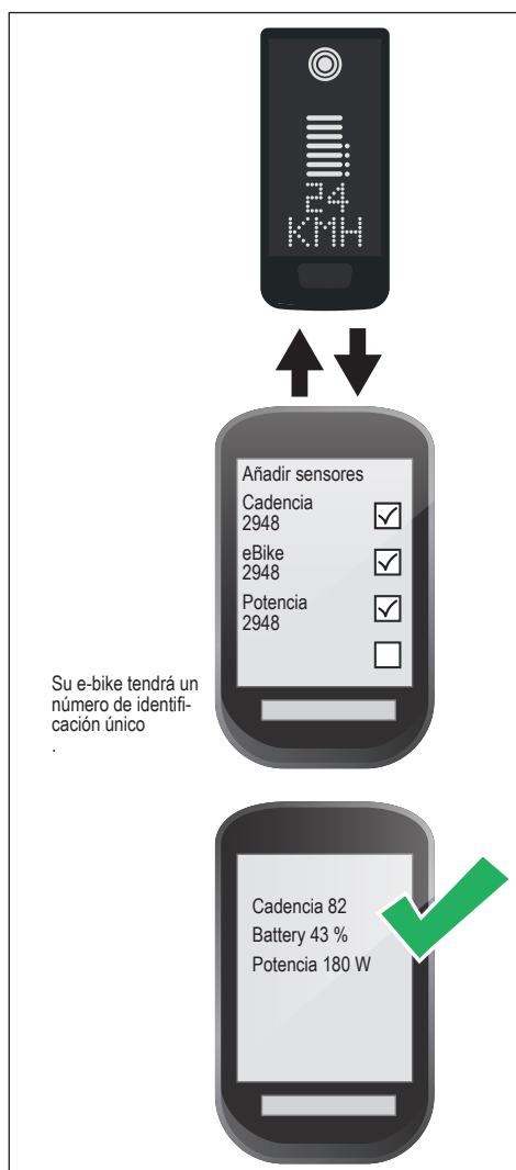
Fig. 8: Conexión de la e-bike al ciclocomputador
